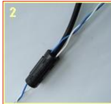
Snadná montáž bezkontaktní čtečky sběrnice CAN ve třech krocích
