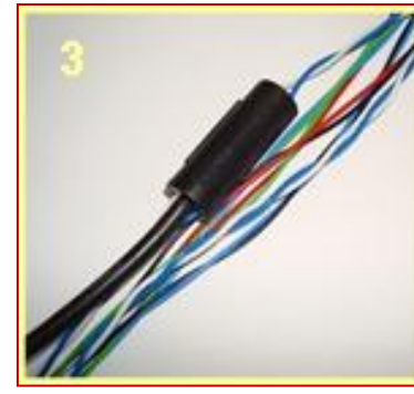
Snadná montáž bezkontaktní čtečky sběrnice CAN ve třech krocích
