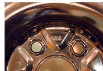
„Zaručené originální“ kola asijské provenience bud vůbec homologaci nemají, nebo homologace neodpovídá požadavkům výrobce automobilu nebo je nekompletní. V tomto případě je na kole vyraženo padělané číslo zboží jiného výrobce.
