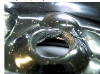
Příliš silná vrstva laku u otvorů pro šrouby může vést k uvolnění šroubů.
