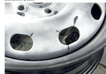
Kolo udávané jako originální výbava pro VW Group: předčasné prasknutí kola u ventilačních otvorů při zátěžovém testu kvůli nosnosti kola 555 kg namísto požadovaných 625 kg.
